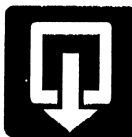
Emplacement d'une sortie ou direction vers une sortie habituellement empruntée par les personnes présentes dans l'établissement
